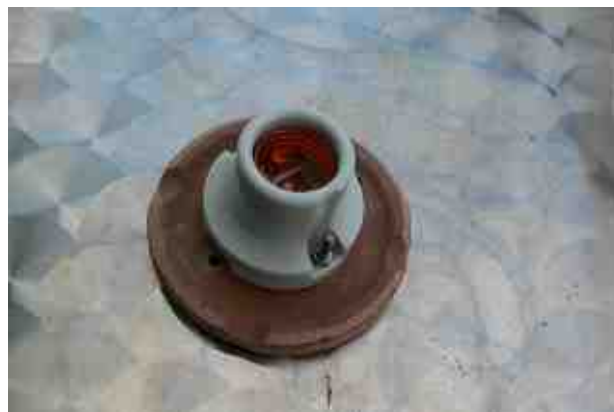
ソケット台の加工とソケットの取り付け
