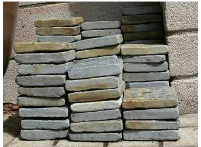
厚みの不揃いな舗石
